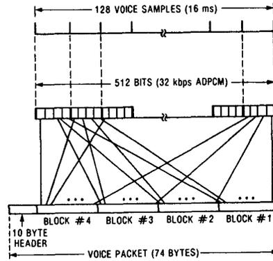
FIGURE 2. ORGANIZATION OF AN EMBEDDED-ADPCM-ENCODED VOICE PACKET
